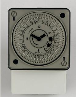
OP-TS171.1 IS A CAPTIVE-TAPPET 7-DAY TIME SWITCH. EACH TAPPET OPERATES FOR 2 HOURS. THE TIMER IS SUITABLE FOR SURFACE, PANEL AND DIN-RAIL MOUNTING. THE 7 DAY DIAL CONTROLS A VOLT-FREE CHANGEOVER SWITCH, WITH A RESISTIVE RATING OF 16 AMPERES.
